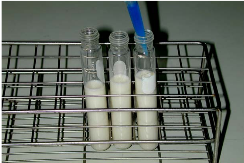
คูดสารละลาย Methylene Blue 1 ml ใส่ลงในตัวอย่างนม
