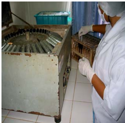
นำไปปั่นนาน 5 นาที ที่ความเร็ว 1100 rpm
